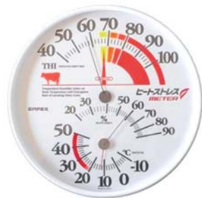
写真1 ヒートストレスメーター THIが一目で分かり、乳牛のストレス度合いを把握しやすい
