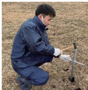
【写真③】 採土器を抜く、上部（○囲み）の土を除外、サンプル袋に詰め必要事項を書いて送る。
