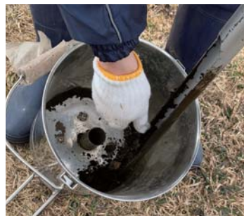
【写真③】 採土器を抜く、上部（○囲み）の土を除外、サンプル袋に詰め必要事項を書いて送る。
