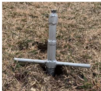
【写真③】 採土器を抜く、上部（○囲み）の土を除外、サンプル袋に詰め必要事項を書いて送る。
