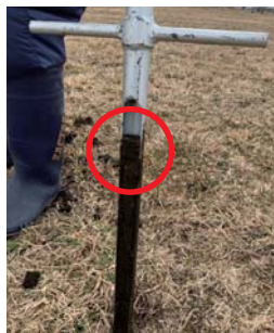
【写真③】 採土器を抜く、上部（○囲み）の土を除外、サンプル袋に詰め必要事項を書いて送る。
