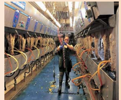
12頭ダブルの平行パララー。4回搾乳・個体乳量 50kg/頭 体細胞12万
